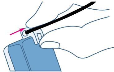
Um das Umhängeband zu entfernen, drücken Sie den kleinen Knopf an dem das Band befestigt ist und entnehmen Sie das Band mitsamt der Vorrichtung.
