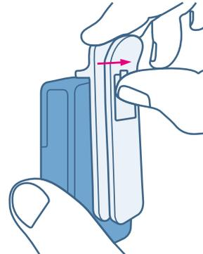
Um den Gürtelclip zu entfernen, drücken Sie den Knopf nach oben und ziehen Sie den Clip vom Mobilteil ab.
