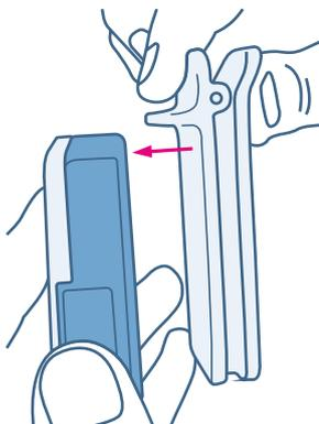
Um den Gürtelclip anzubringen, befestigen Sie diesen über den Einschub an der Rückseite des Mobilteils.
