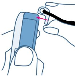
Schieben Sie den Clip auf das Mobilteil und befestigen Sie so das Umhängeband (Lanyard).
